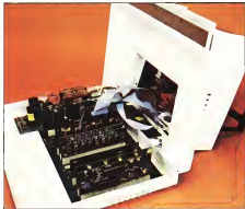
Per aprire la macchina basta estrarre la vite a brugola sul frontale. Il processore e i componenti vengono alloggiati su una piastrina mobile con una serie di slot per le varie schede.
